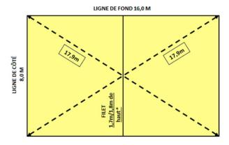
Assurez-vous d'abord que la surface du sable est uniforme et plane avant de délimiter le terrain. Assurez-vous que les coins sont à angle droit et que la distance entre les coins opposés est de 17,9 m  $\pm$  2 cm. Si les dimensions réelles sont différentes, ajustez les rubans en conséquence.
